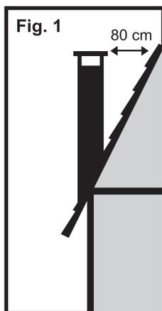
Em telhados com bastante inclinação tipo chalés, construa a chaminé conforme o seguinte sistema:
